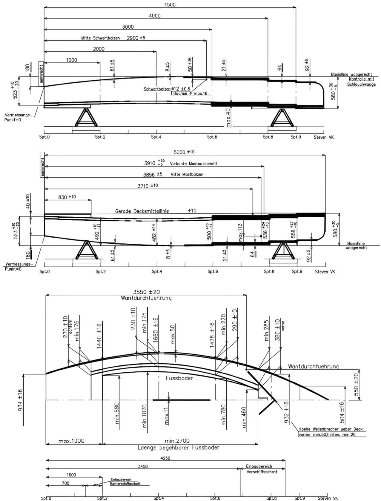
**Abb. 4: Schnitt Spant 4, beispielhaft**
